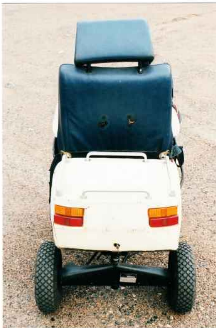
Kuva 13. Lampujen aiheuttama vaurio istuimessa.
