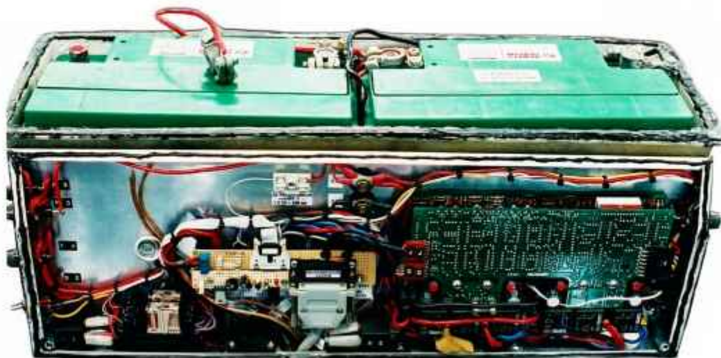
Kuva 41. Koekäyttölaitteen rele- ja elektronikkayksikkö. Oikealla puolella on ajo-ohjain Curtis PMC 1202A.
