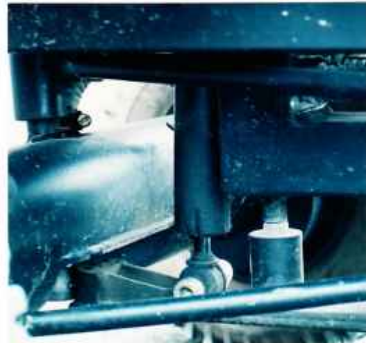
Kuva 35. Koekäyttölaitteen alustaa. Pystyasennossa keskellä on alapäästään lehtijouseen kiinnitetty iskunvaimennin.
