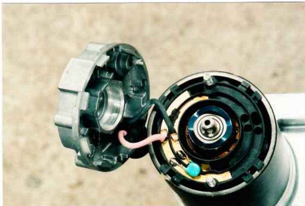
Kuva 61. Ajomoottorin häiriönpistokondensaattori tinattuna kiinni hiilisiltaan.
