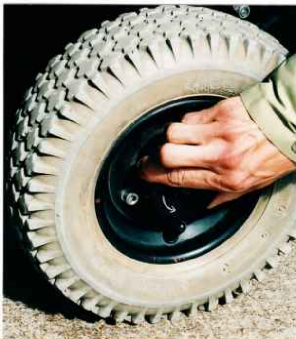
Kuva 43. Koekäyttölaitteen seisontajarrujen vapauttimien käyttö.
