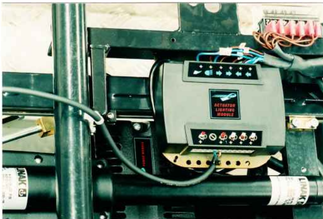
Kuva 85. Pilot+ -järjestelmän ALM-yksikkö (Actuator & Lighting Module) asennettuna tuotantomalliin. Yksikköön on kytketty kuvan alaosassa näkyvä painopisteen säädön karamoottori.
