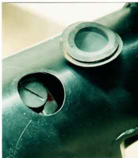
Kuva 27. Koekäyttölaitteen ajomoottorin hiilen tarkastusaukko ja kumitulppa.
