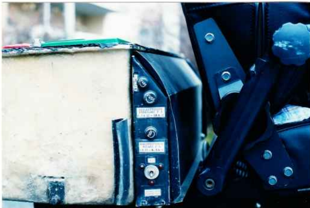
Kuva 47. Koekäyttölaitteen sulakkeita rele- ja elektronikkayksikön päädtyissä. Alhaalla oleva kytkin oli kokeilumielessä tehty erillinen seisontajarrujen vapautin. Kotelon toisessa päädtyssä oli latauksen sulake.
