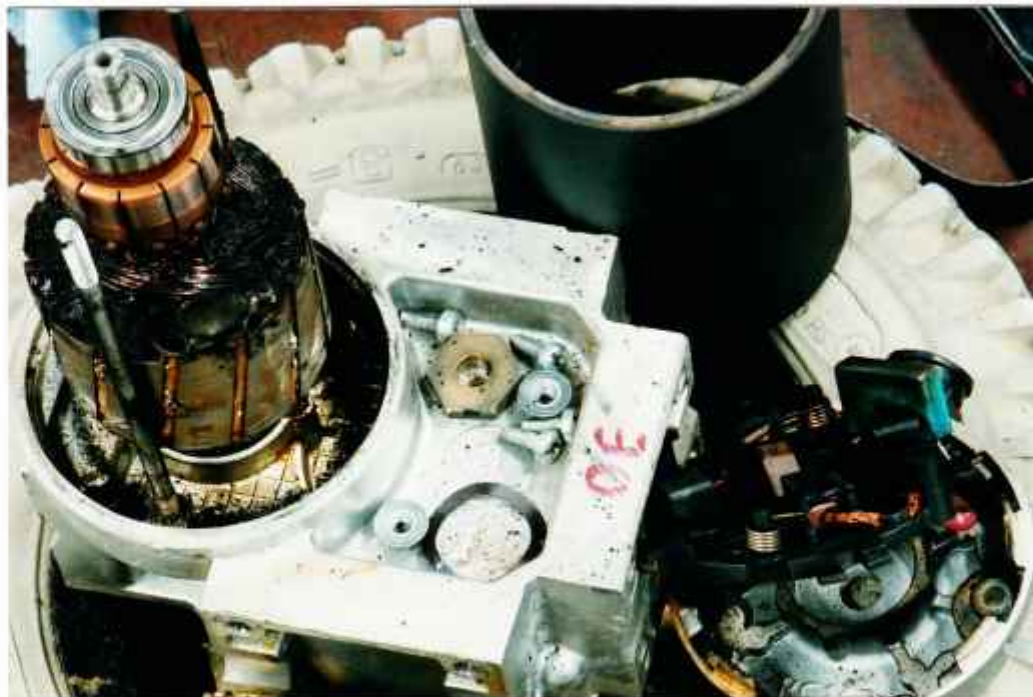
Kuva 88. Voimakkaan ylikuormituksen seurauksena ylikuumentunut ajomoottorin ankkuri, joka on osittain oikosulkeutunut sisäisesti.
