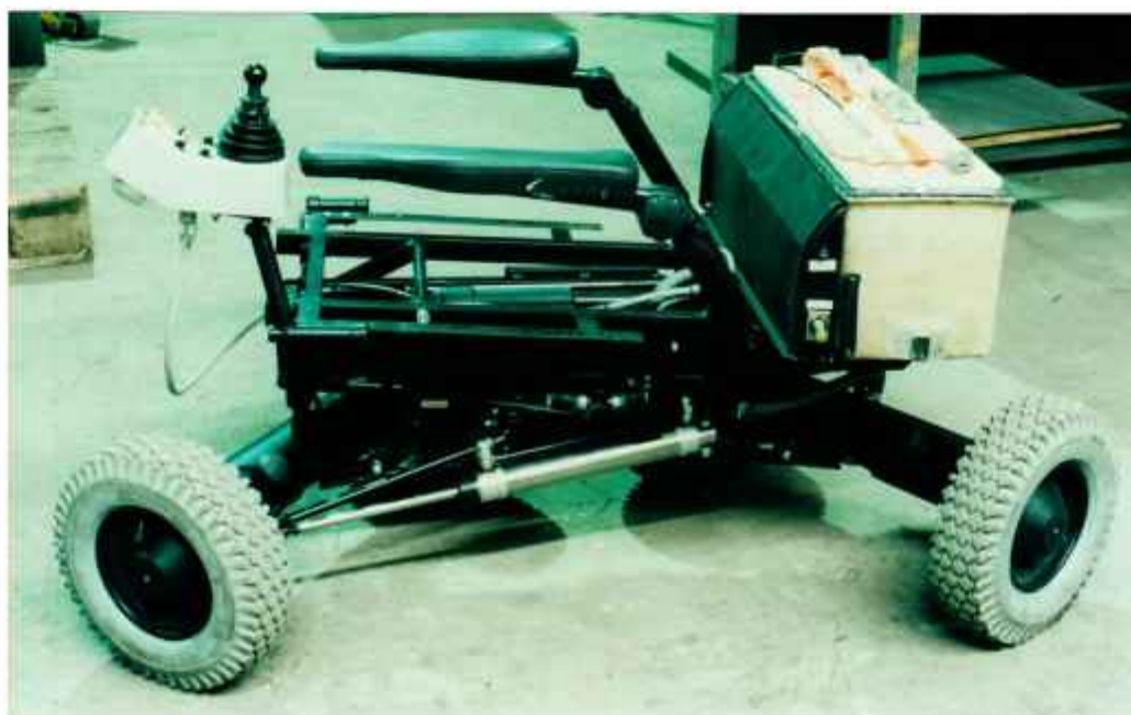
Kuva 33. Koekäyttölaite rakenteilla. Alustassa oleva vaalea laite on hydraulisylinteristä konstruoitu säädettävä ohjausiskunvaimennin.
