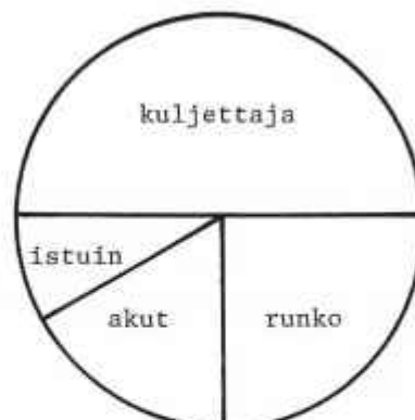
Kuva 8. Sähköpyörätuolin kokonaispainon likimääräinen muodostuminen.
