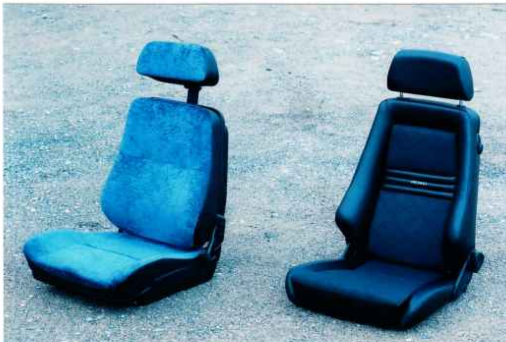
Kuva 76. Kaksi tuotantomallin istuinvaihtoehtoa. Vasemmalla puolella on kotimaista valmistetta oleva (Savon Verhoilu ky), josta oli useita koko- ja väri variaatioita. Vasemmalla puolella on Recaron perusmalli.
