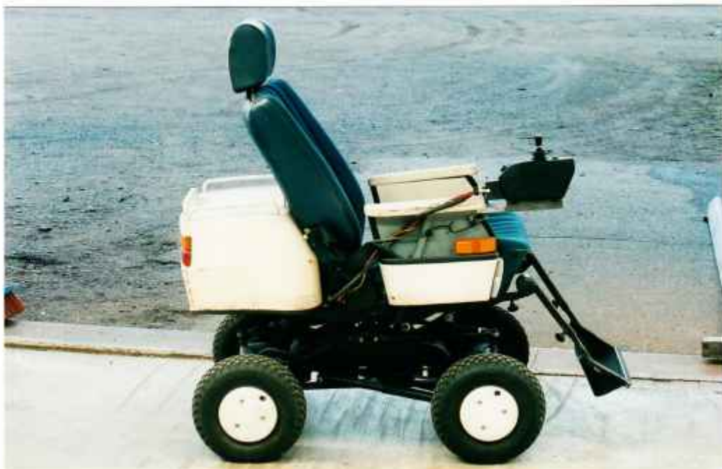
Kuva 57. Ajo-ohjain asennettuna prototyyppiin testauksia varten.
