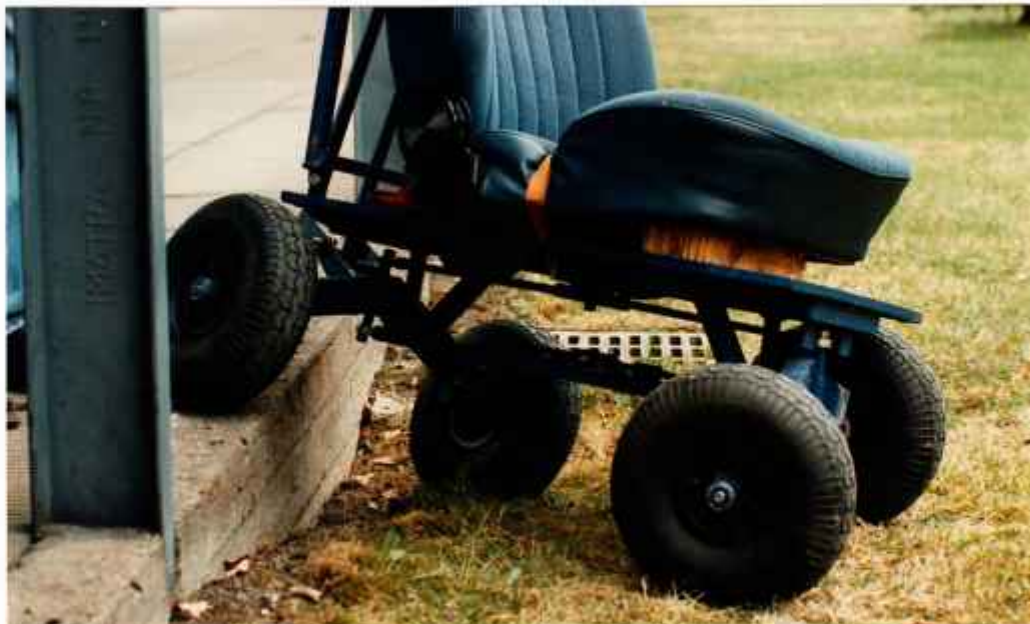
Kuva 6. Ajoneuvon istuin kiinnitettynä kuljetusvaunuun.
