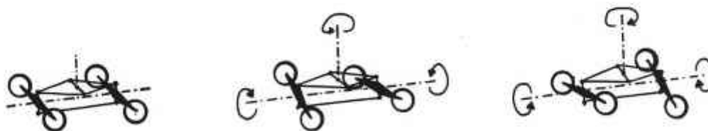
Kuva 3. Akselien sivuttaisen kallistuksen toiminta.
