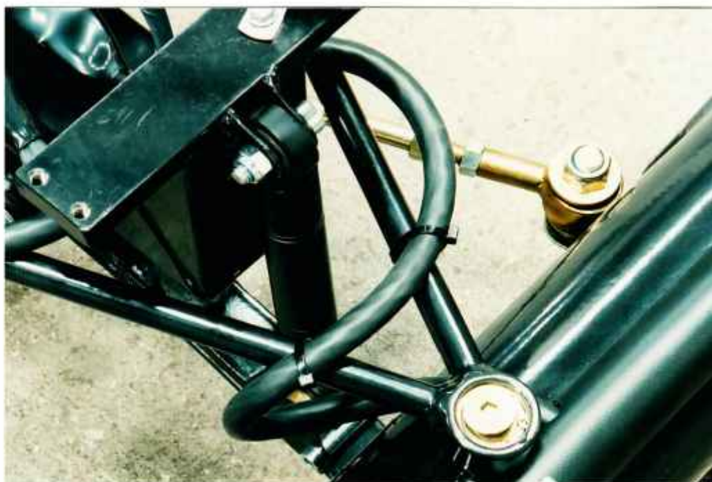
Kuva 67. Akselin kaapeloinnin kohta, jossa esiintyy jatkuvaa kiertoliikettä.
