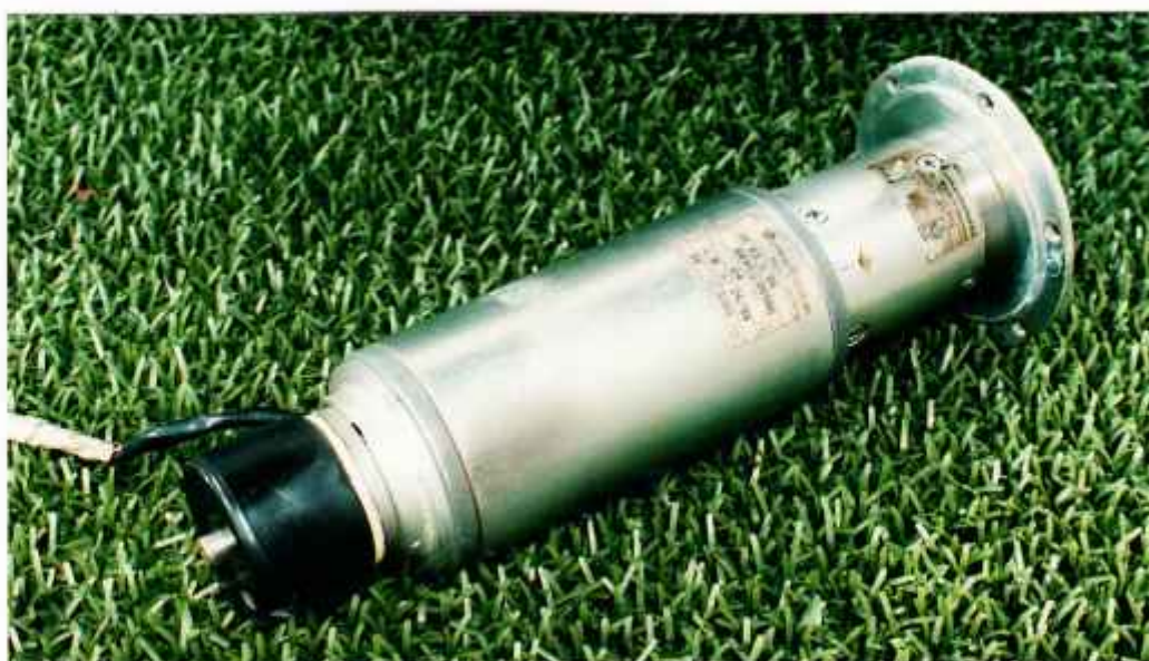
Kuva 9. Prototyypin ajomoottori. Vasemmassa päädyssä on seisontajarru.
